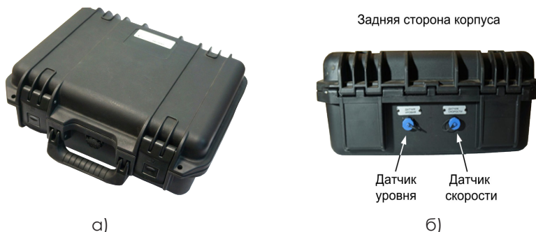
Рисунок Б.10 – Вид корпуса кейса с ЭБ для мобильного варианта исполнения расходомера: а) внешний вид; б) разъемы на задней стенке кейса для подключения измерительных датчиков
