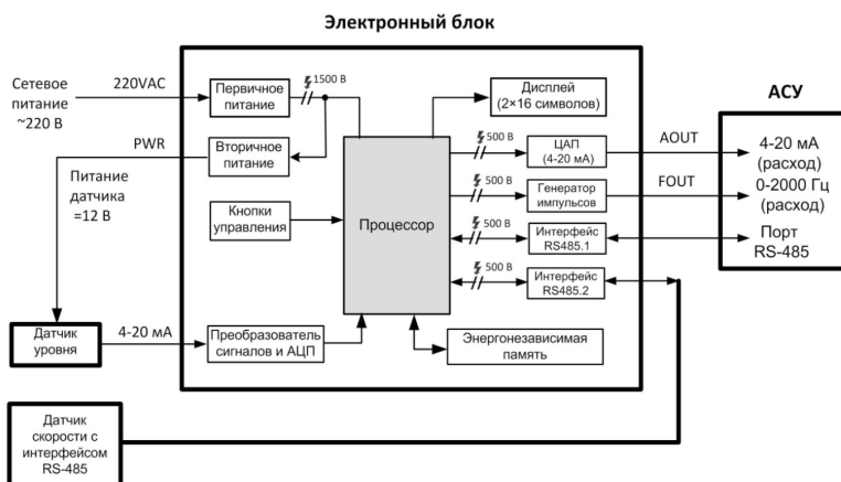
Рисунок 3.1 – Функциональная схема стационарного исполнения расходомера, поясняющая работу: а) базовая комплектация; б) типовой вариант для применения широкого перечня датчиков уровня и скорости
